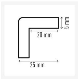
**Durable Eckschutzprofil C20 magnetisch,
