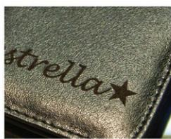
Auf Metall, Kunststoff und auch Leder brennt der Laser eine haltbare Vertiefung in die Oberfläche. Diese Art der Individualisierung ist durch das Einbrennen eine beinahe unauslöschliche Kennzeichnung. Eine Gravur ist auch auf Gravurplättchen möglich.
