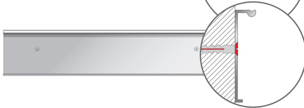
Für die **Gewährleistungsgarantie** müssen beiliegende Sicherungshalter (3b - 6b) montiert sein.
