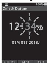
Durch Drücken der F2-Taste (24H) während der Stunden- und Minuteneinstellung können Sie zwischen der 12- und 24-Stundenanzeige wählen.
