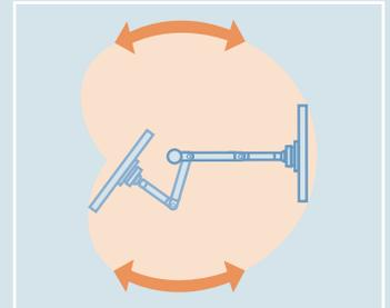
Die TSS-Faltarme sind dank ihres mehrteiligen Gelenkarms horizontal so weit schwenkbar, dass aus jedem Blickwinkel um die gesamte Säule herum eine optimale Monitorbetrachtung möglich ist.
