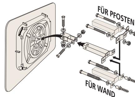
Universal-Halterung für Wände und Pfeiler mit einem Querschnitt von 60 bis 90 mm. Erlaubt eine sehr präzise Einstellung der Spiegelposition. Widerstandsfähigkeit wurde getestet bei Windstärken bis zu 183/h.
