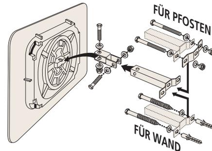
Universal-Halterung aus feuerverzinktem Stahl, für Wände und Pfeiler mit einem Querschnitt von 60 bis 90 mm. Erlaubt eine sehr präzise Einstellung der Spiegelposition. Widerstandsfähigkeit wurde getestet bei Windstärken bis zu 183km/h.
