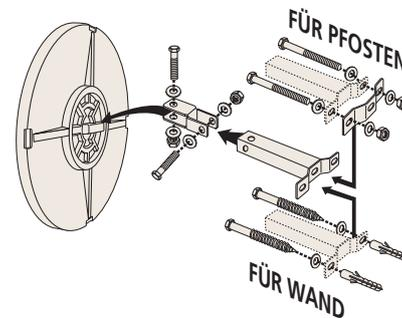
Universal-Halterung für Wände und Pfeiler mit einem Querschnitt von 60 bis 90 mm. Erlaubt eine sehr präzise Einstellung der Spiegelposition. Widerstandsfähigkeit wurde getestet bei Windstärken bis zu 183/h.
