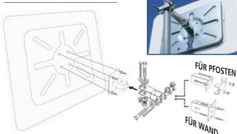
Universal-Halterung aus feuerverzinktem Stahl, für Wände und Pfeiler. Für Rundpfosten (Ø 76 bis 90 mm) oder Vierkantpfosten (60x80 oder 80x80mm). Erlaubt eine sehr präzise Einstellung der Spiegelposition.
