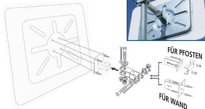
Universal-Halterung aus feuerverzinktem Stahl, für Wände und Pfeiler. Für Rundpfosten (Ø 76 bis 90 mm) oder Vierkantpfosten (60x80 oder 80x80mm). Erlaubt eine sehr präzise Einstellung der Spiegelposition. **Ausschließlich zur Montage auf Stahlpfosten geeignet.**
