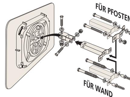
Universal-Halterung für Wände und Pfeiler mit einem Querschnitt von 60 bis 90 mm. Erlaubt eine sehr präzise Einstellung der Spiegelposition. Widerstandsfähigkeit wurde getestet bei Windstärken bis zu 183/h.
